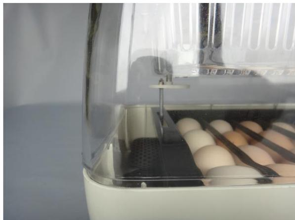
Fig. 4: une tige en métal permettant de tourner automatiquement le plateau d'œufs est présente dans le couvercle. La tige doit être insérée dans l'emplacement du plateau à œufs qui lui permet de glisser pour déclencher la rotation lente des œufs. Le moteur de ce système de retournement s'allume dès que l'appareil est sous tension. Il fonctionne selon un cycle de quatre heures, il est donc très lent. L'œuf tourne complètement sur lui-même une fois toutes les 4 heures environ.
